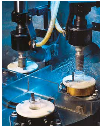
Das Vor- und Fertigreiben von NS-Hülsen erfolgt auf Mehrstationen-Anlagen.
